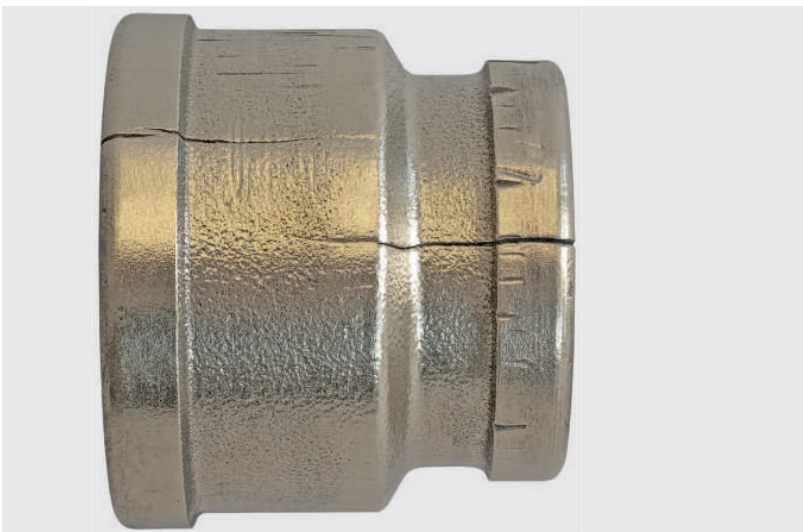
Abb. 18: Schadenbild Spannungsrisskorrosion an einem Schraubfitting
