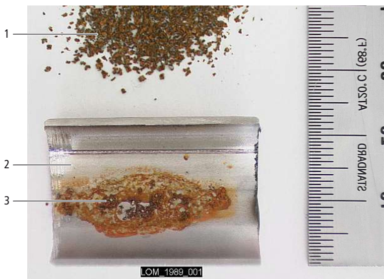
Abb. 38: Korrosion von Metallspänen in einem Edelstahlrohr
