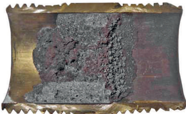
Abb. 31: Schadenbild Kalkablagerungen in Messing-Fittings (Bild: Suisstec Merkblatt W10019)
